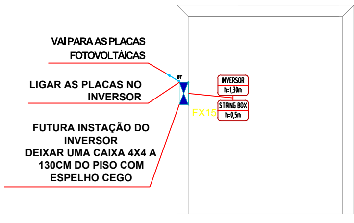
DETALHE DA INSTALAÇÃO DA FOTOVOLTAICA ESCALA 1:50
